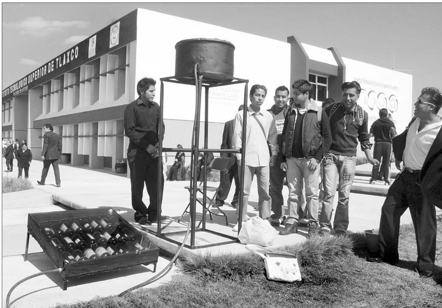
El calentador de agua que crearon los alumnos del ITST puede calentar el líquido desde los 20 grados centígrados hasta los 70 en un día despejado en un lapso de 15 a 20 minutos ■ Foto Alejandro Ancona
